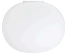
Deckenleuchte für diffuses Licht. Diffusor bestehend aus einem mundgeblasenem, verschaltem Opalglas mit geätzter Außenfläche und einem Halterring mit Gewinde aus druckgegossener Aluminiumlegierung, galvanisch verchromt. Deckenhalterung bestehend aus einem Element aus zu 30% glasfaserverstärktem Polyamid und der Diffusorhalterung aus druckgegossener, graufarbig flüssiglackierter Aluminiumlegierung.
